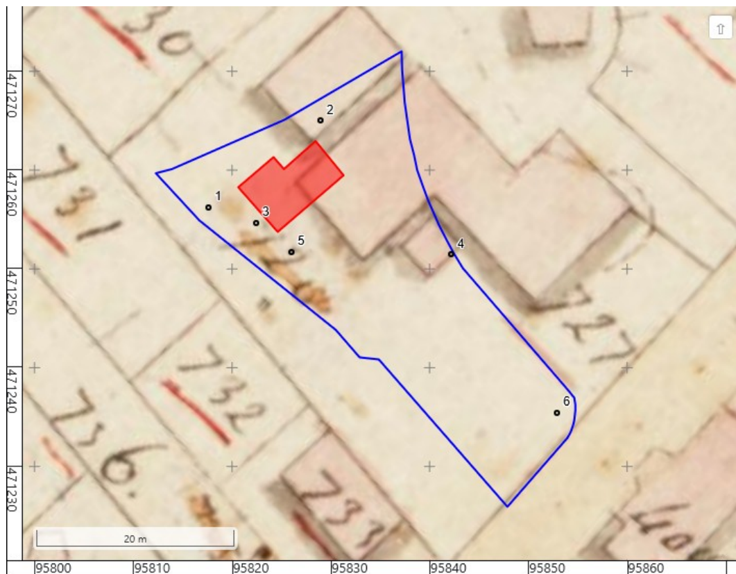
Figuur 7: Het kadastraal minuutplan met daarop geprojecteerd de locatie van de halfverdiepte kelder (rood) en boorpunten.
