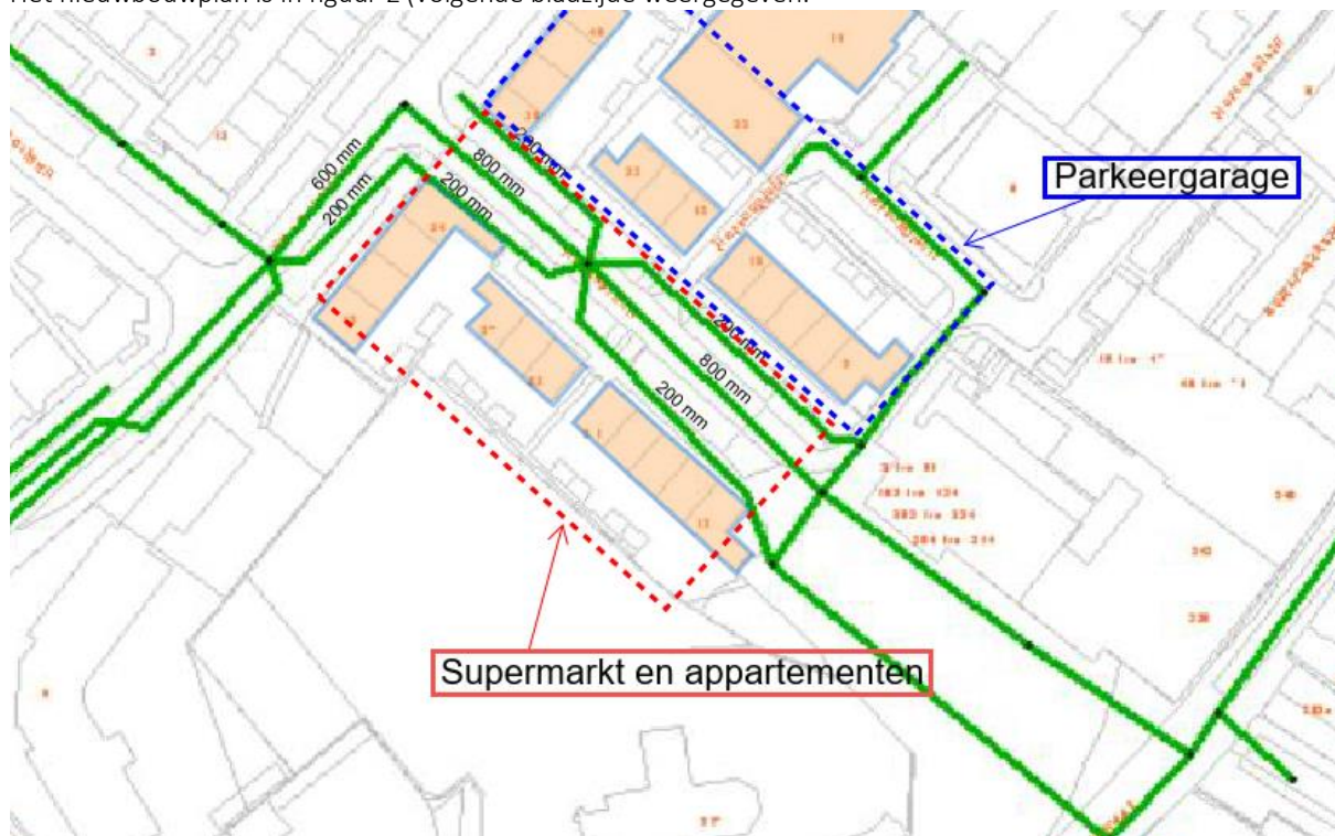
Figuur 1: Rioleringsplan en werkzaamheden bij het Hortusplein te Sassenheim.
