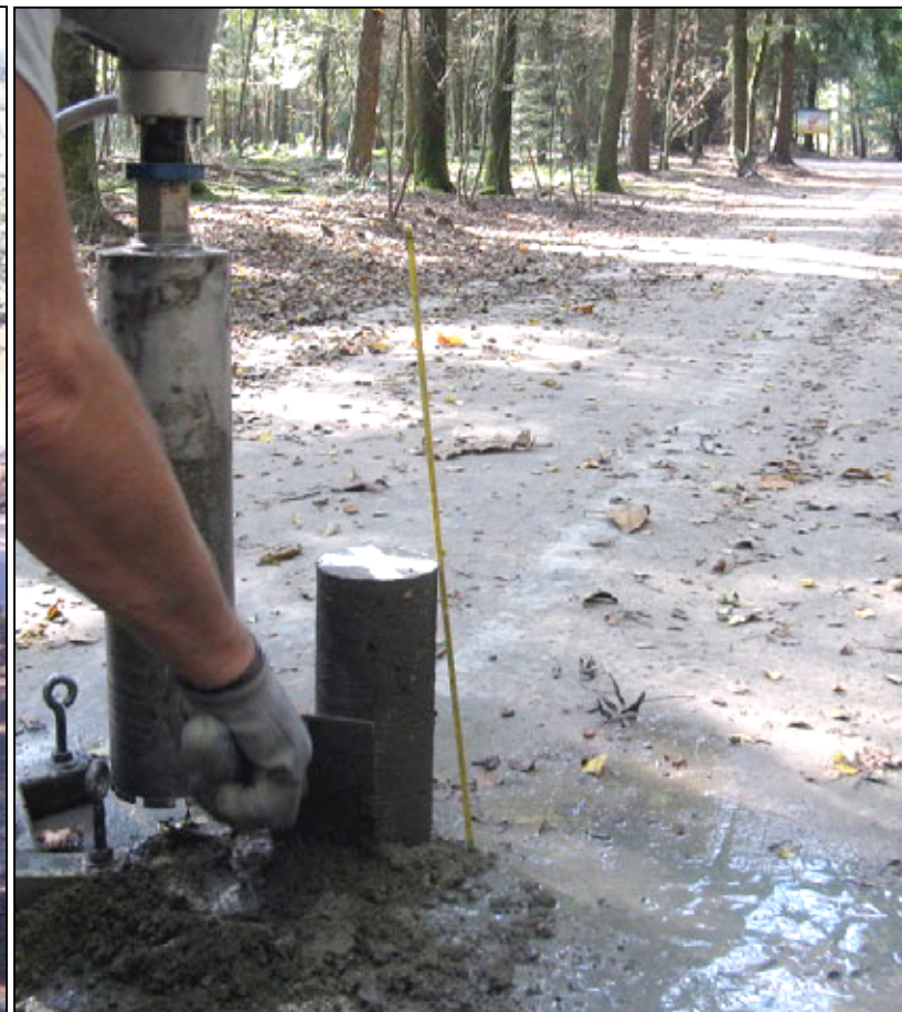
Afb. 12: :Het nemen van boorkernen uit het GeoCrete® stab oppervlak.
